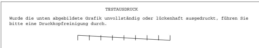
Bei ordnungsgemäß eingesetzter Tintenpatrone sollte die Testgrafik wie abgebildet aussehen. Ist der Ausdruck unvollständig oder lückenhaft, reinigen Sie bitten den Druckkopf, wie auf Seite 117 beschrieben.
