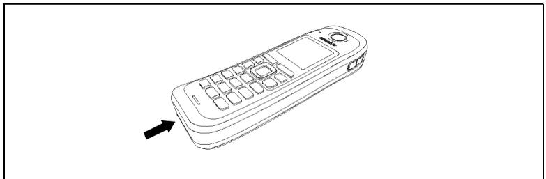
Entfernen Sie den Stopfen nur zum Laden, zum Anschluss eines schnurgebundenen Headsets oder zum Anschluss eines Datenübertragungskabels.
