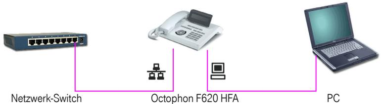
➡ Sie benötigen zum Verbinden des Octophon F620 HFA mit einem PC nur ein handelsübliches Netzwerk-Kabel (kein gekreuztes Kabel).
