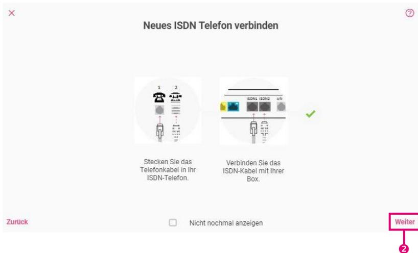
1. Schließen Sie Ihr ISDN Telefon an einen internen ISDN-Anschluss (*ISDN1* oder *ISDN2*) der **Digitalisierungsbox** an.
