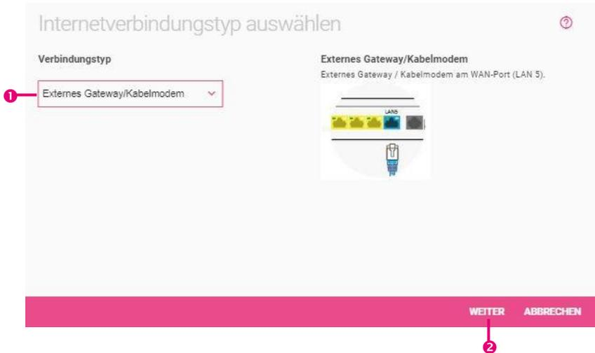
1. Bei **Verbindungstyp** legen Sie fest, wie der Internetzugang in Ihrem Netzwerk bereitgestellt werden soll. Wählen Sie *Externes Gateway/Kabelmodem* aus. Stellen Sie sicher, dass das Gerät, über das die Internetverbindung hergestellt wird, korrekt mit einer der verfügbaren Ethernet-Schnittstellen verbunden ist!
