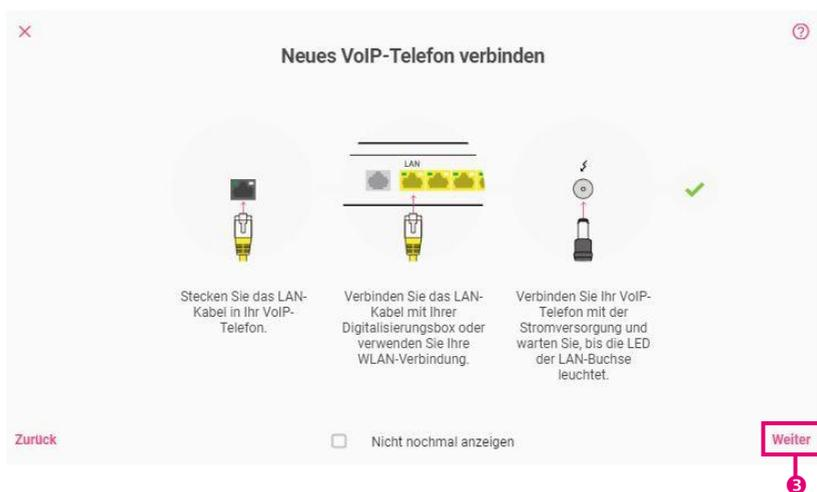
1. Schließen Sie Ihr VoIP-Telefon mit dem Ethernet-Kabel an einen LAN-Anschluss (*LAN1 – LAN4*) der **Digitalisierungsbox** an.
