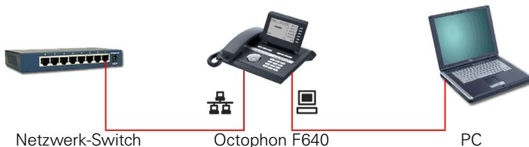
Durch diese Anschlussart sparen Sie jeweils einen Netzwerk-Anschluss des verwendeten Switches und benötigen bei entsprechender Anordnung weniger Netzwerk-Kabel bzw. nutzen kürzere Leitungswege.
