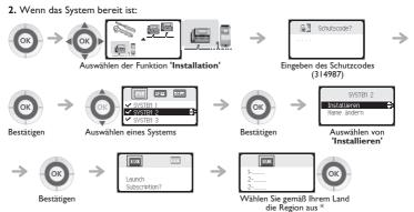
Der DECT-Apparat kann programmiert werden und auf den 4 festgelegten Frequenzbereichen arbeiten. Bei der Installation muss der Benutzer eines DECT-Apparats das Gerät für den Frequenzbereich des entsprechenden Landes deklarieren:
