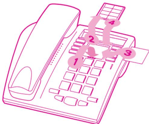
1. Einen Gegenstand mit flachem Ende in die Kerbe einführen (eine Kerbe pro Tastenblock).
