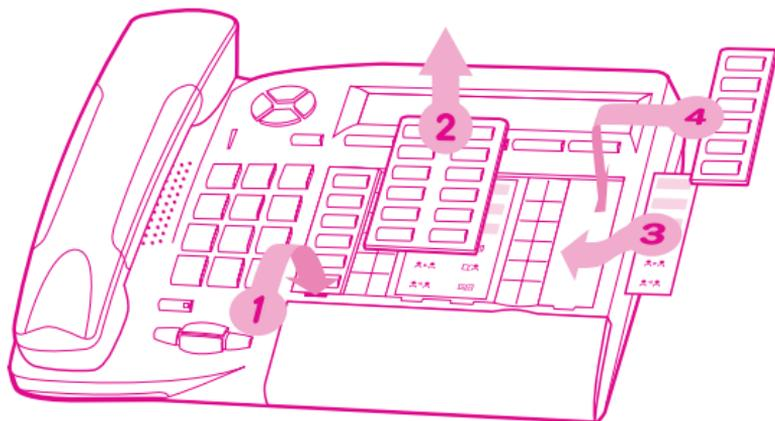
1. Einen Gegenstand mit flachem Ende in die Kerbe einführen (eine Kerbe pro Tastenblock).
