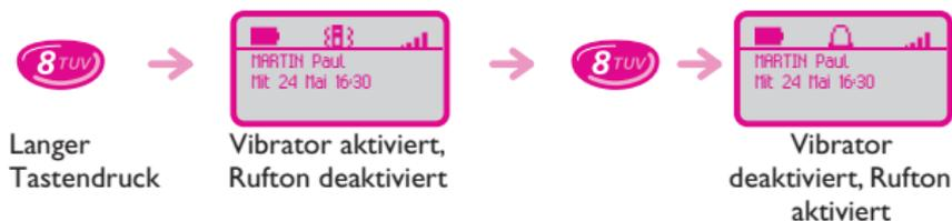
Diese Taste ermöglicht es, schnell zwischen Rufton und Vibrator hin- und herzuschalten.
