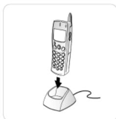
Ladegerät an das Netz anschliessen und DECT-Handset in die Ladestation einlegen
