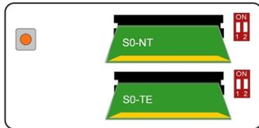
Abb. 13: Mini-Module zur ISDN-Anschlusskonfiguration und Reset-Taster
