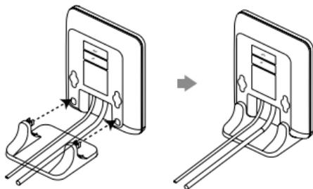
Richten Sie die Einrasthaken an den entsprechenden Öffnungen aus und drücken Sie diese in die Öffnungen hinein bis sie einrasten.
