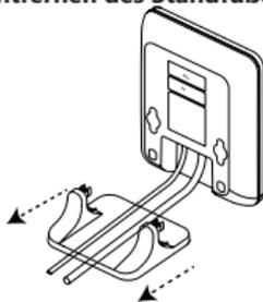
Entfernen Sie die Einrasthaken indem Sie sie in horizontaler Richtung aus Öffnungen herausziehen.
