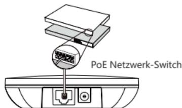
Hinweis: Bei Inline-Stromversorgung (PoE) muss das Netzteil nicht angeschlossen werden. Vergewissern Sie sich, dass der Netzwerk-Switch PoE-kompatibel ist. Die Basisstation darf nur mit dem originalen Netzteil (5 V/600 mA) betrieben werden. Bei Verwendung eines Drittanbieter-Netzteils kann die Basisstation beschädigt werden.
