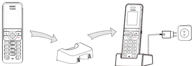
Hinweis: Das Mobilteil darf nur mit dem originalen Netzteil (5 V/600 mA) betrieben werden. Bei Verwendung eines Drittanbieter-Netzteils kann das Mobilteil beschädigt werden.
