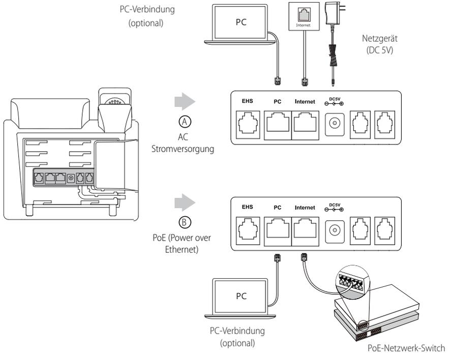
**Hinweis:** Das IP-Telefon darf nur mit dem originalen Yealink Netzteil (5V/1,2A) genutzt werden. Die Verwendung eines Netzteiles eines Drittanbieters kann zu einer Beschädigung des Telefons führen. Bei einer Online-Versorgung (PoE) muss das Netzgerät nicht angeschlossen werden. Vergewissern Sie sich, dass der Netzwerk-Switch PoE-kompatibel ist.
